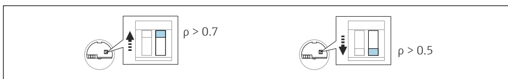
53 Положение переключателя на электронной вставке для регулировки плотности
